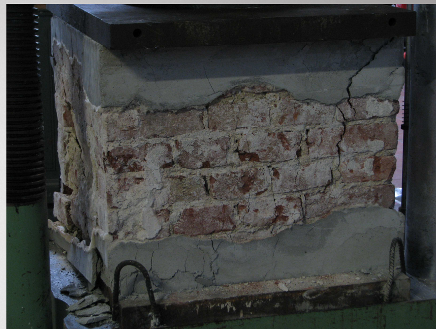
Campione dopo la rottura a compressione
