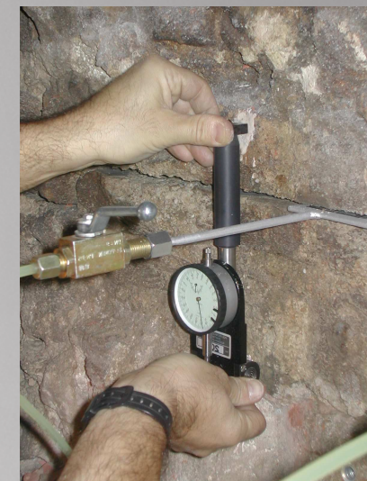
Misura della variazione di lunghezza delle basi
