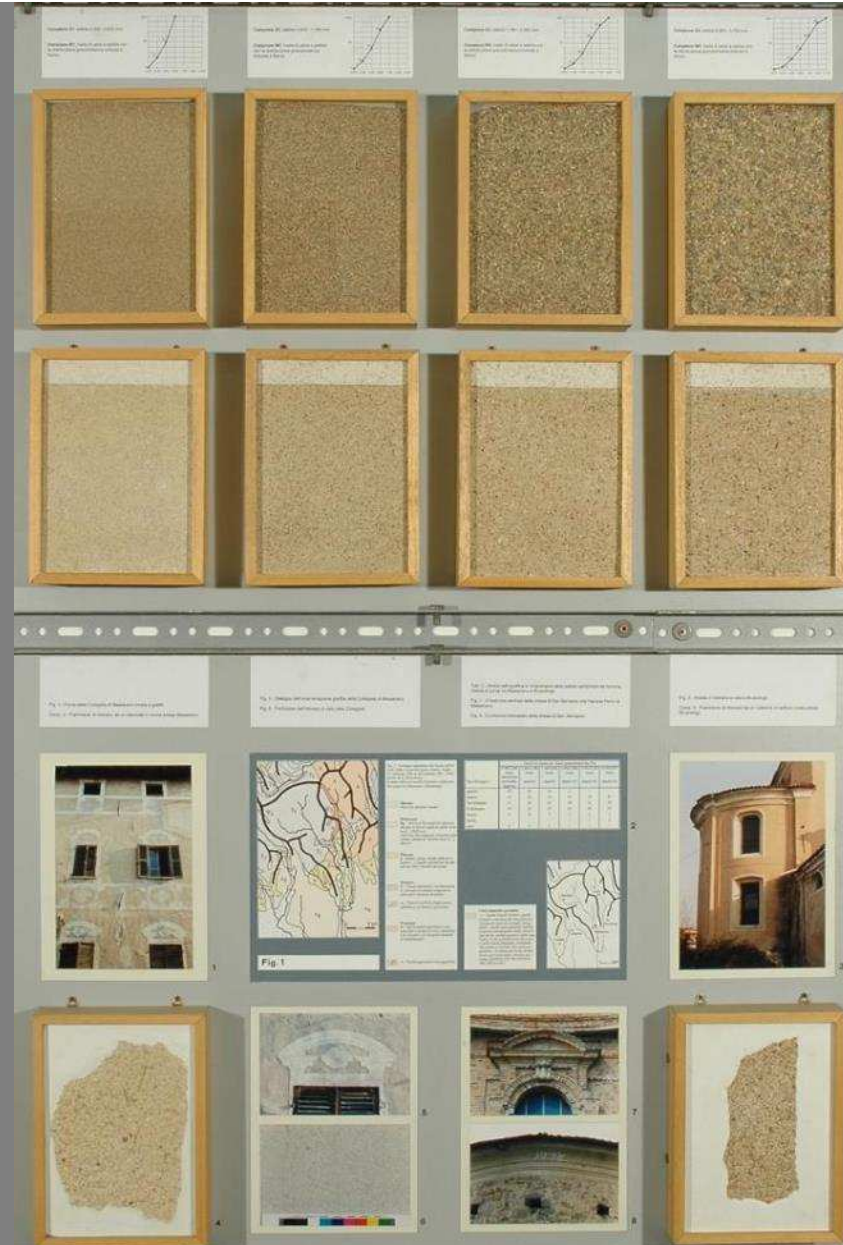
Laboratorio DISEG - Collezione di sabbie locali e di malte ottenute con sabbie localmente disponibili
